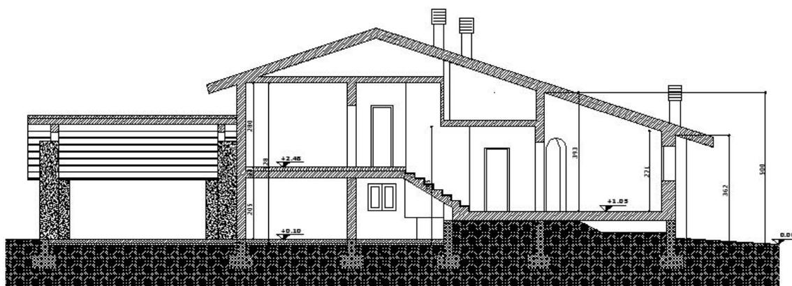
Figura5: Sezione del fabbricato allo stato di fatto
