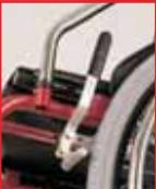
Estrazione rapida dell'asse di trasmissione.
