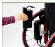
La batteria aggiuntiva permette di estendere l'autonomia del propulsore di ulteriori 7 km, sostituendo rapidamente quella in uso.
