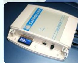
Il modulo SS-400 consente di connettere gli apparati **SAFEGUARD**, di protezione di un varco al sistema di supervisione "**SAFEGUARD Manager**".
