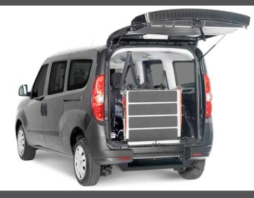
Rampa di accesso: in 2 parti, alluminio antiscivolo, Misure 1550 x 780 mm
