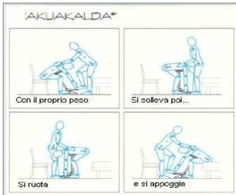
Figura 2: schema di funzionamento di Akuakalda
