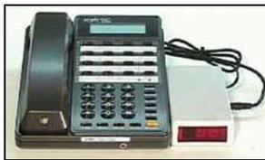
Easy Handsfree Phone ed Easy Phone: si tratta di un telefono vivavoce adattato e dell'apposito ricevitore a raggi infrarossi compatibile con Easy Rider. Il ricevitore Easy Phone è un modulo che deve essere installato tra il telefono (Easy Handsfree Phone) ed il cavo telefonico. È in grado di codificare i raggi infrarossi provenienti dal telecomando (Easy Rider) attivando le seguenti funzioni:
