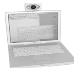
HEADMOUSEEXTREME Produttore Origin Instruments Co Mouse utilizzabile col movimento del capo
