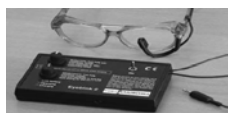
EYE BLINK SWITCH Produttore Tobychurchill-Fapi Sensore a IR, trasforma il movimento laterale dell'occhio o l'abbassamento della palpebra in segnale di attivazione
