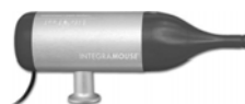
INTEGRAMOUSE Produttore Life Tool Dispositivo di puntamento a bocca; il click sn e dx vengono azionati soffiando e succhiando aria
