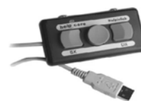
HELPICLICK Produttore Helpicare Joystick. Il cilindro governa i movimenti del cursore e i pulsanti laterali attivano il click dx e sn del mouse
