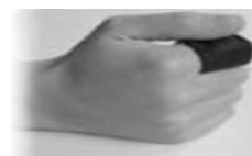
FINGERBUTTON Produttore Intellitools Formato da una fascetta, da tenere come un anello sull'indice, attivata da una pressione con presa laterale dal pollice
