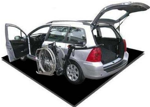
Il caricamento della carrozzina può essere manuale (meglio scegliere, in questo caso, portiere scorrevoli), oppure si può ricorrere ad un braccio meccanico che è in grado di caricarla su un portapacchi posteriore o sul tetto.
