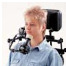
**Figura 81 Comando con sensore di calore**
