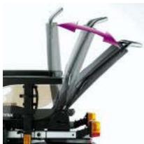
Alcune carrozzine hanno la possibilità di basculare, reclinare, inclinare l'appoggiagambe elettronicamente in modo da consentire la posizione supina e il riposo risparmiando, così, i trasferimenti (si tratta di modelli costosi e ingombranti).
