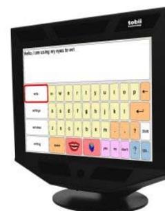
Figura 101 Computer con puntatori oculari
