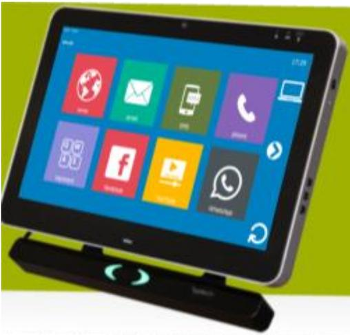
Altrimenti insieme al sistema hardware (computer con sistema di puntamento oculare) viene fornito un **software con un'interfaccia semplificata**, attraverso cui gestire le funzioni principali del computer, come la videoscrittura, la navigazione in internet, la posta elettronica, la multimedialità.
