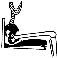
Fig. 6 Da seduto, le tuberosità ischiatiche sporgono in basso rispetto ai femori.. Per questo è opportuno che il sedile sia leggermente più basso nella sua parte posteriore. (Disegno tratto da Engstrom B.: Ergonomics; wheelchairs and positioning . Ed. Bromme Tryck, Sweden, 1993).
