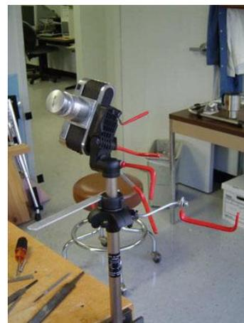
**Figura 5.4:** Adattamento delle leve per gli snodi del tripode per macchina fotografica
