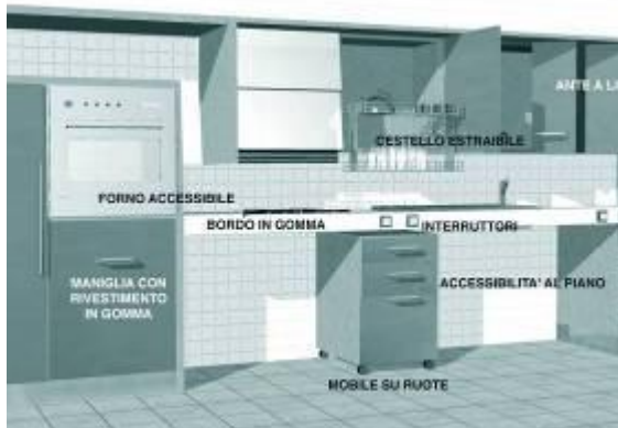
Fig.10.5 Lay-out ipotetica cucina accessibile
