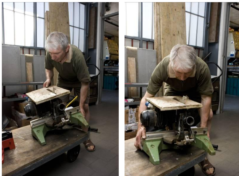
Fig.11.3 Manovre di sollevamento
