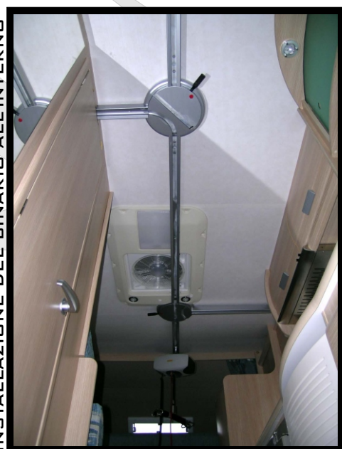
INSTALLAZIONE DEL BINARIO ALL'INTERNO
