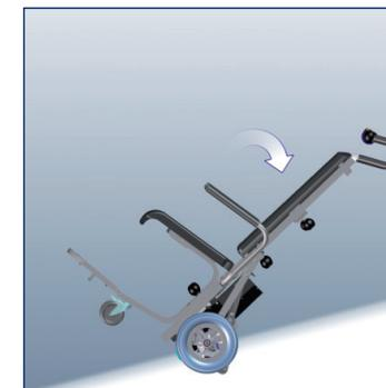
Per rallentare, inclinare ulteriormente c-max U1, affinché si possano attivare i freni di sicurezza.
