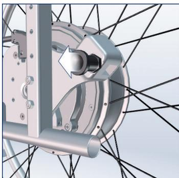
Estrarre il perno di fissaggio del supporto (9).
