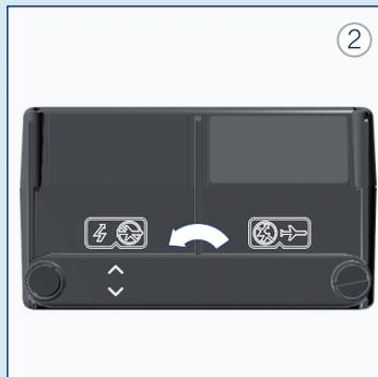
Ruotare l'interruttore e inserirlo. Fare attenzione alla freccia, aereo barrato!
