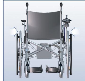
Montare le ruote con asse flottante. Osservare le figure 4-6!
