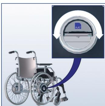
Ruotare il meccanismo di sblocco.
