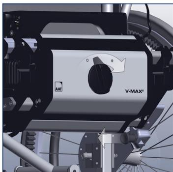
Ruotare completamente verso destra l'interruttore di sblocco. Gli alberi motore escono.
