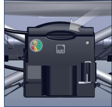
Infilare nella presa di carica del pacco batterie l'interfaccia premontata sulla sedia a rotelle.
