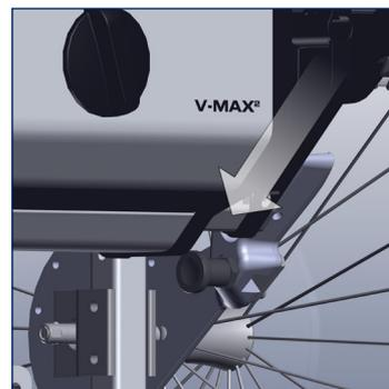
Inserire completamente l'unità motrice nel supporto della sedia a rotelle prestando attenzione alla correttezza del posizionamento.
