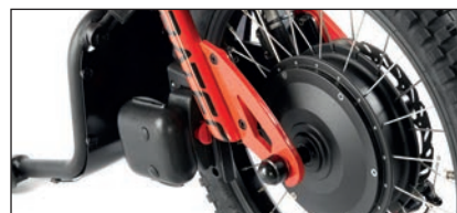
Staffa destra rimovibile per favorire il cambio pneumatico o camera d'aria.
