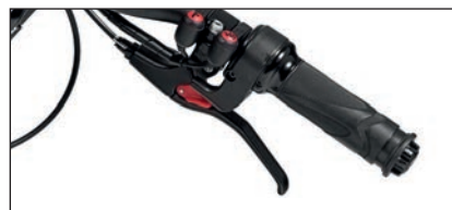
Freni meccanici Avid BB5 e leva in alluminio con freno di parcheggio.
