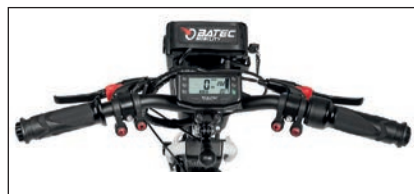
Manubrio in alluminio nero opaco con sistema di rotazione per lo stoccaggio.
