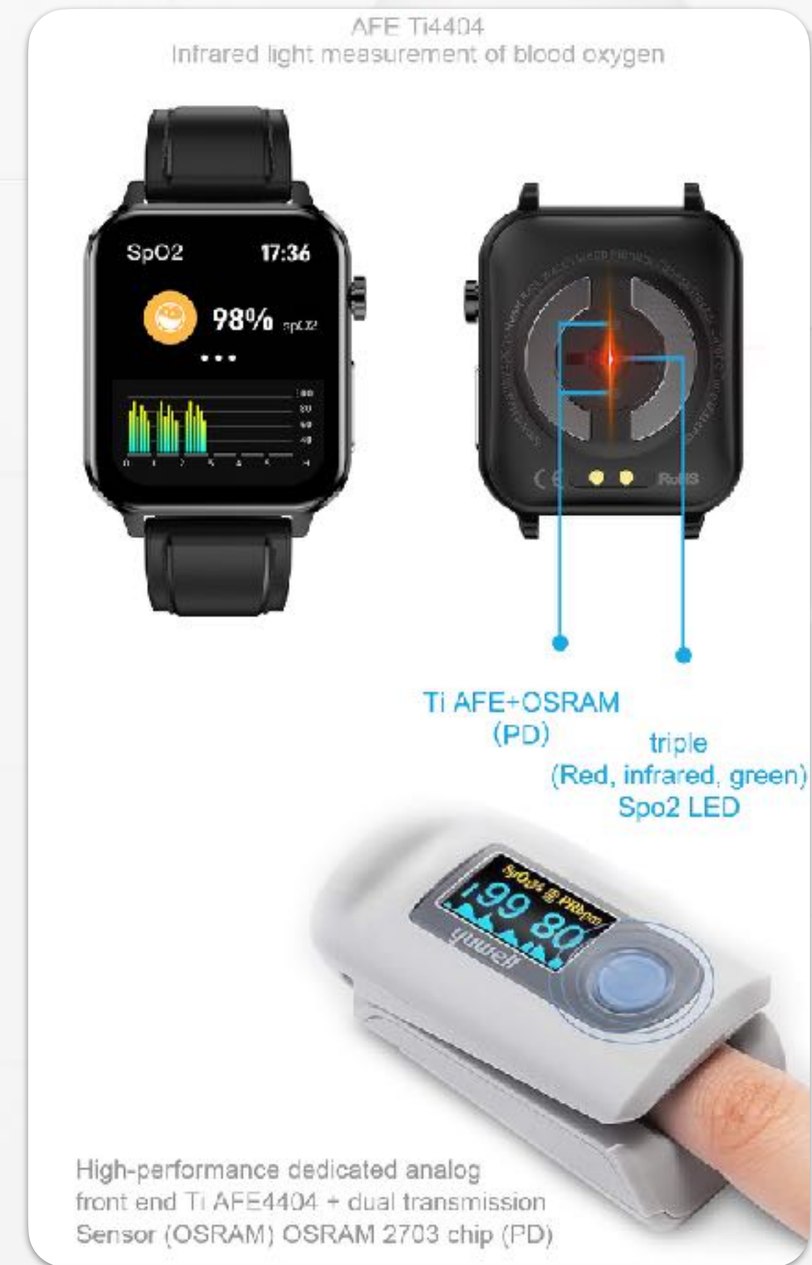
Misurazione della saturazione con sensore PPG dedicato
