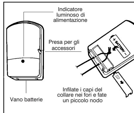
Fig. 4 - Trasmettitore a distanza
