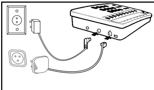
Fig. 5 - Collegamento del cavo telefonico e dell'alimentatore/adattatore
