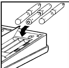
Fig. 3 - Vano batterie
