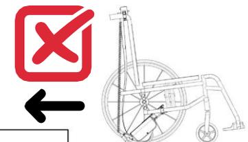
Prestare particolare attenzione quando si oltrepassano ostacoli, come i cordoli, ad esempio. Gli ostacoli possono essere oltrepassati mediante l'ausilio del motore di Enjo, ma solamente muovendosi lentamente in avanti. L'altezza massima dell'ostacolo è di 5 cm (a seconda delle ruote anteriori della carrozzina). La carrozzina deve essere abbassata mediante le maniglie, se necessario. Se è necessario oltrepassare un ostacolo in retromarcia, il dispositivo Enjo deve essere spento.
