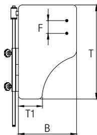
Tavolino per carrozzina in PET trasparente, nella versione per utenti emiplegici, è dotato di **braccetto ribaltabile** per fissaggio sul bracciolo destro e sinistro. Lo spessore di 8 mm garantisce un'ottima resistenza. Attacco regolabile rispetto alla profondità della seduta.
