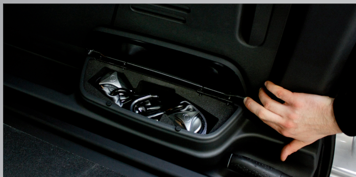
Vasca alloggiamento ancoraggi
