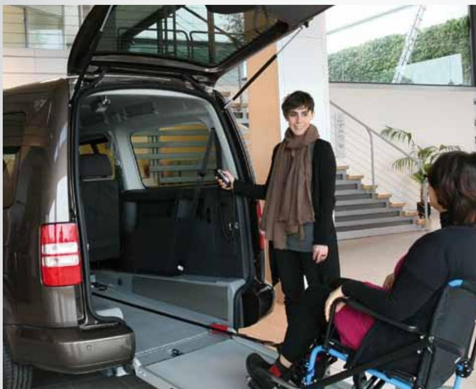
**F-Winch è il verricello che consente di trainare la carrozzina su una rampa in modo sicuro e confortevole.**
